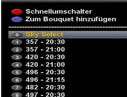
Beim Drücken der **Option** Taste im TV Modus sehen Sie eine Liste der Unterkanäle. Navigieren Sie mit dem Pfeiltasten ▼▲ zu dem gewünschten Unterkanal und bestätigen Sie mit **OK**. Mit den Pfeiltasten ◀▶ schalten Sie zum nächsten Unterkanal
