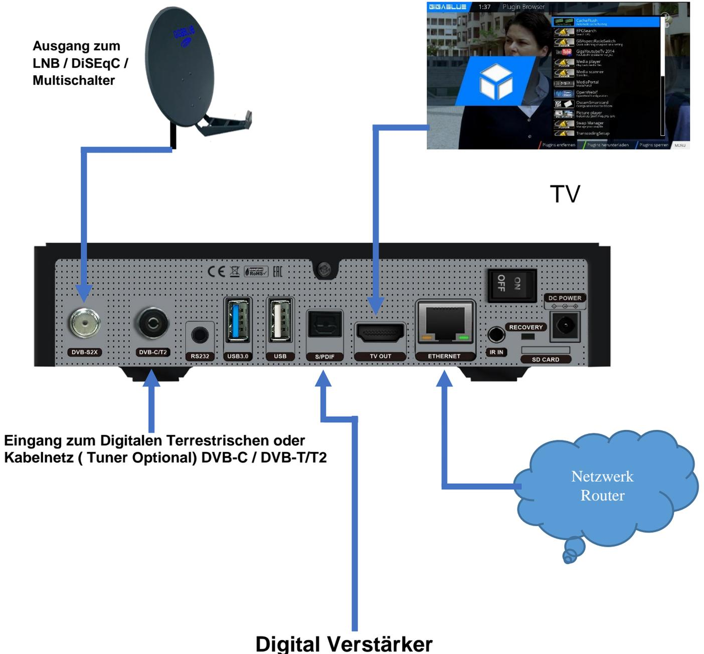
Die GigaBlue Box verfügt über einen optischen Ausgang. Damit können Sie den Digital Verstärker über ein optisches (LWL) Kabel verbinden.
