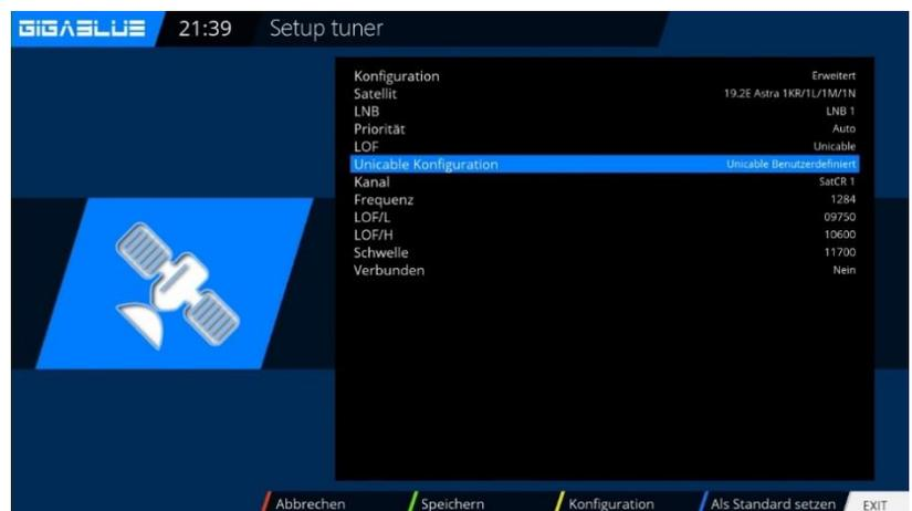
**Sind mehrere Tuner vorhanden, so muss jedem Tuner ein eigener Kanal zugewiesen werden**
